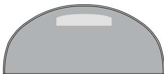
Geschlossener Giebel mit Lüftungsöffnung
