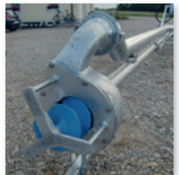
Unteneinlaufpumpe mit robuster Einzugsschnecke
