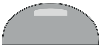
Geschlossener Giebel mit Lüftungsöffnung
