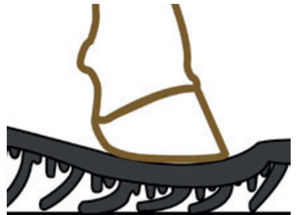
Die Stützknoppen federn beim Aufstehen und Abliegen mit.
